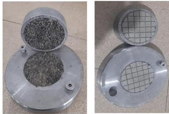
Gambar 1. Variasi Kekasaran Benda Uji pada alat Modified Direct Shear
