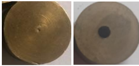
Gambar 1. Permukaan Spesimen Sebelum dan Sesudah Perendaman Selama 10 Hari
