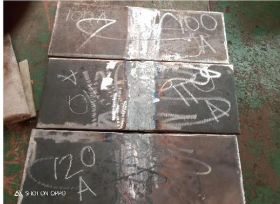
**Gambar 4.1** Hasil Pengelasan Pengujian
