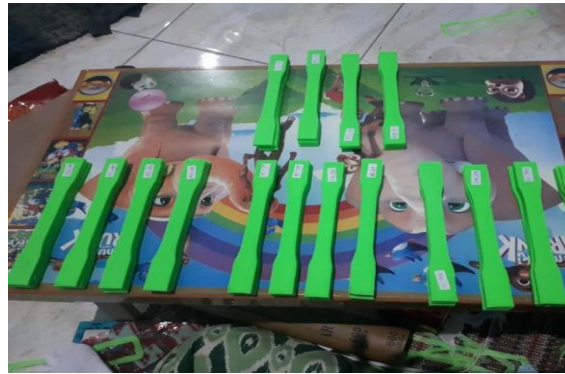
Gambar 3 Desain Spesimen Uji Tarik
