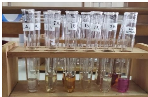
Gambar 2. Sampel Positif formalin berwarna kuning kecoklatan hingga tidak berwarna
